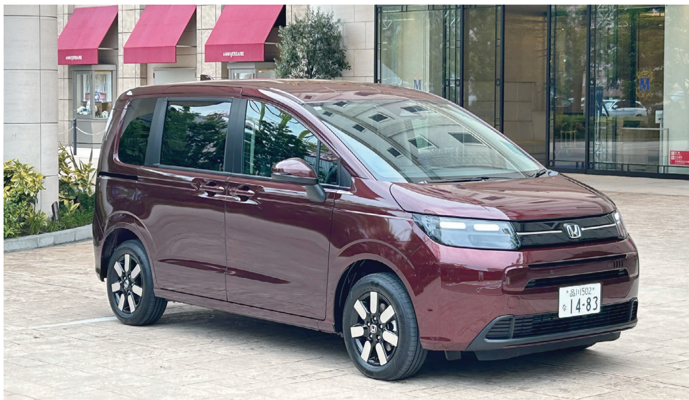
ホンダ フリード ●ボディサイズ4310×1695×1755 (4WDは1780)mm ●パワートレイン 1.5ℓ直4ガソリン (87kW) + モーター (78+90kW) ●税込価格250万8000円～343万7500円
