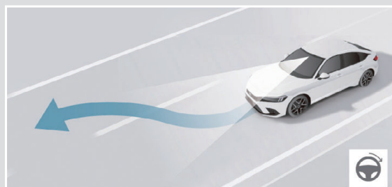
車線変更支援機能。ウィンカー操作後、システムがステアリング操作を支援する
