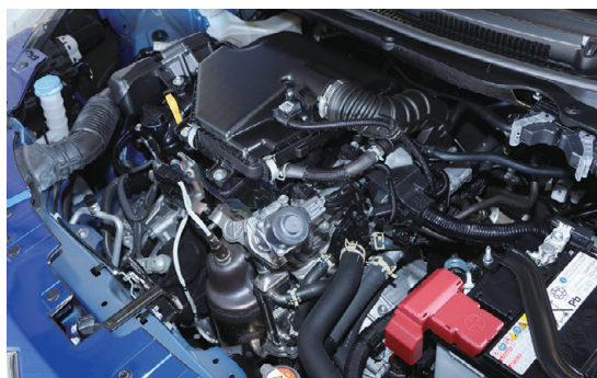
Z12E型エンジンは最高出力60kW/5700rpm、最大トルク108Nm/4500rpmを発揮。低速から滑らかに上昇するトルク特性
