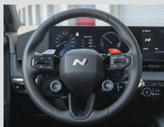
ステアリング上のNボタンでN e-Shiftがオンになる。そのほかモード選択ボタン、パドルなどが装備される
