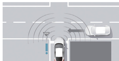
前方交差車両警報。交差点で交差車両との衝突危険を検知してドライバーに警告する
