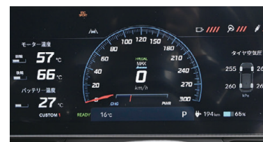
フルスケール300km/hのスピードメーター。ターンパイクを激しく攻めてもバッテリー温度はそれほど上がらない
