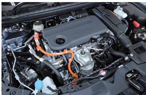
高効率なアトキンソンサイクルエンジンと2モーター内蔵の電気式CVTで、スポーティな走りと低燃費性能を両立
