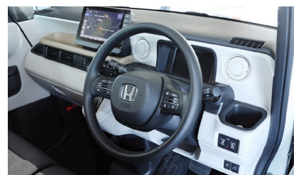
インパネフードのフラット化やフロントビラーの形状変更により視界は格段に向上した
