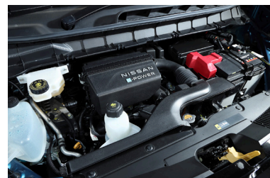
セレナ最上級モデル ルキシオンは、第2世代の新開発1.4ℓ e-POWER専用HR14DDeエンジンを搭載する
