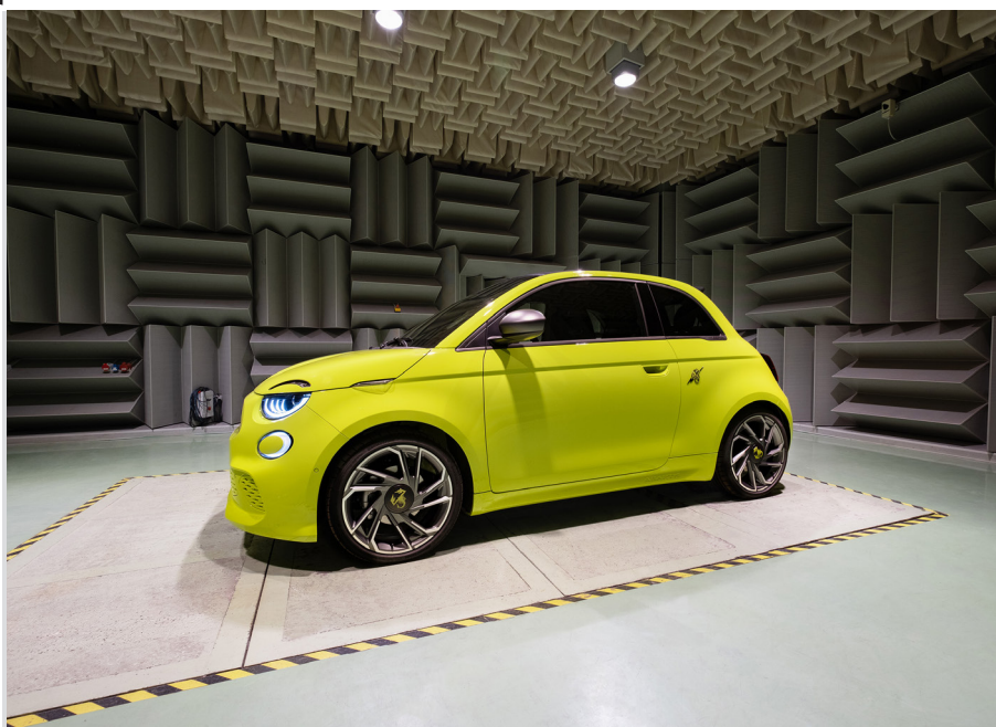
半無響室で音を検証。ベースのFIAT500eとモーターそのものは同じであり、差別化のためにも迫力のサウンドが必要だったと思われる
