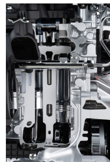
HR12DE型の83.6mmから、100mmまでストロークを延長。シリンダーにミラーボアコーティングを施した
