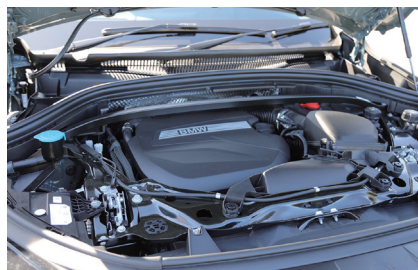
最高出力150kW/5000rpm、最大トルク300Nm/1450-4500rpmを発揮する2.0ℓガソリンエンジン
