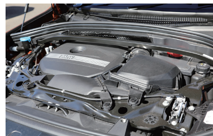
2.0ℓディーゼルエンジンは、最高出力110kW/4000rpm、最大トルク360Nm/1500-2500rpm、14kW、55Nmのモーターで、システムトータル120kW、400Nmを発揮
