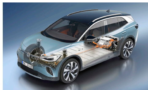
ID.4の透視図。2WDではリアにモーターを置くが、「ID.」にはFWDのモデルも存在する
