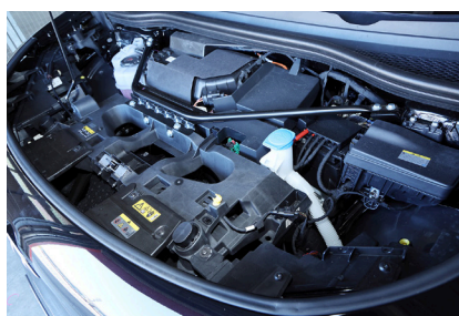
100%電気自動車として開発されたプラットフォームを採用。ボンネット下には最小限の補器類などがまとめられている
