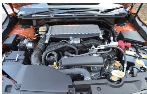
水平対向エンジンにインタークーラー付きターボチャージャーは、クラシカルな雰囲気だが唯一無二のもの
