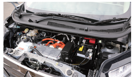
ボンネット下にインバーターや補器類などがコンパクトに収容されている
