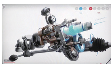
EVモード：モーターで駆動。①（モーター）→②→④
