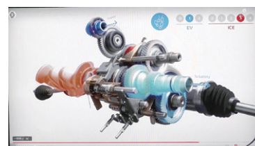
駆動と逆の経路をたどってメインモーター、あるいはHSGと協調して減速回生する
