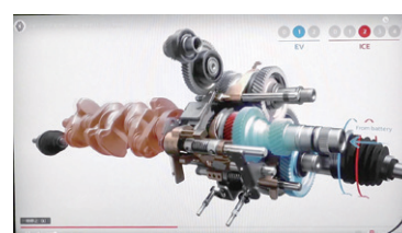
パラレル走行：モーターとエンジンが協調して走行。速度や負荷に応じてギヤチェンジ
