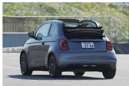
キャンバストップは電動で開閉。後部まで開くので開放感を味わえる。モーターは前輪を駆動
