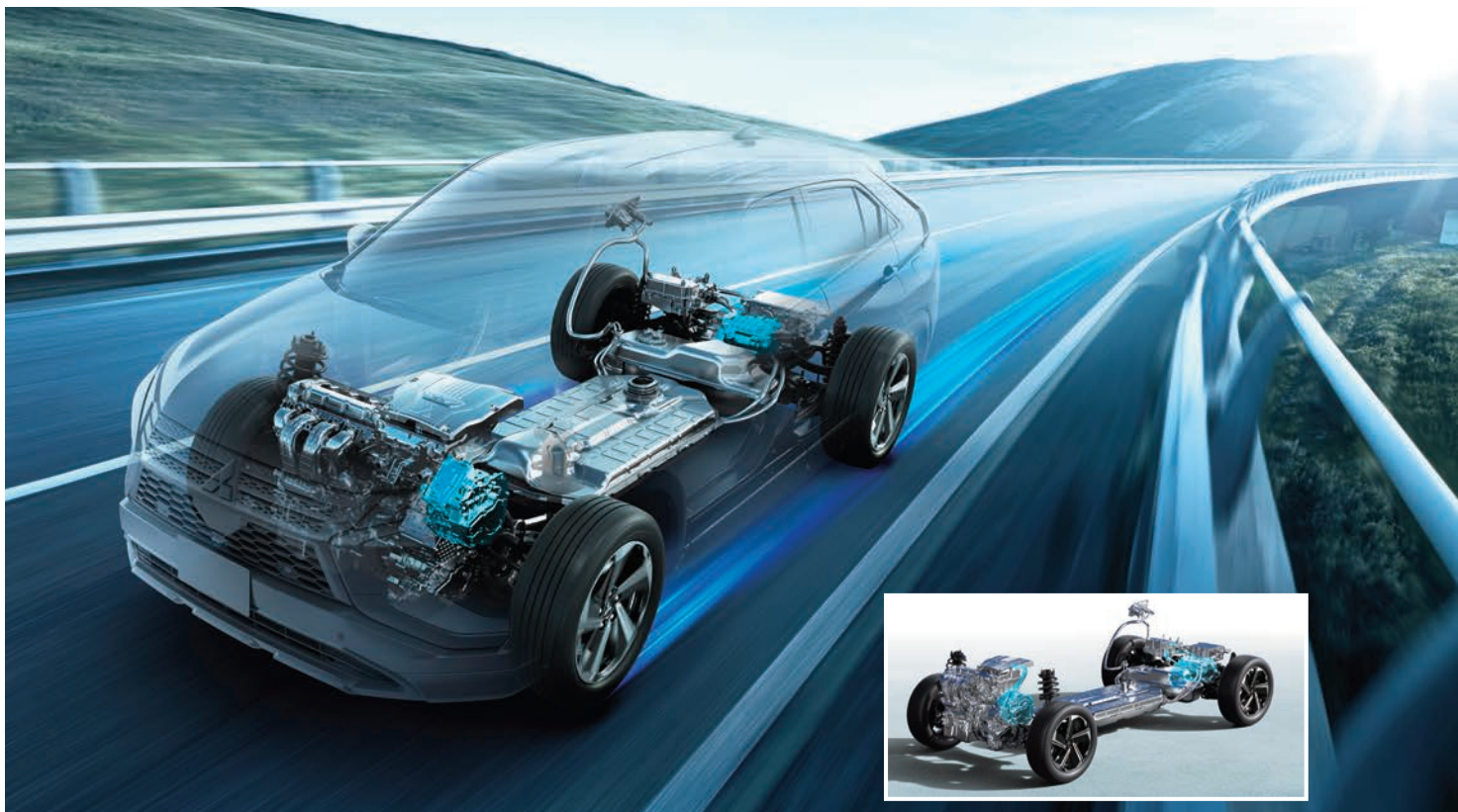
システム構成写真。前部にエンジン、モーターを備えるほか、リアにもモーターを持つ4WD車
