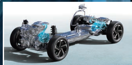
システム構成写真。前部にエンジン、モーターを備えるほか、リアにもモーターを持つ4WD車
