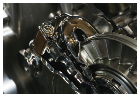
トルクコンバーターのダンパーの剛性を下げた。
