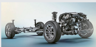
BMWの前輪駆動(FF)アーキテクチャー。1シリーズ、X1、X2にも採用されている。写真は2シリーズ アクティブ ツアラーのもの。
