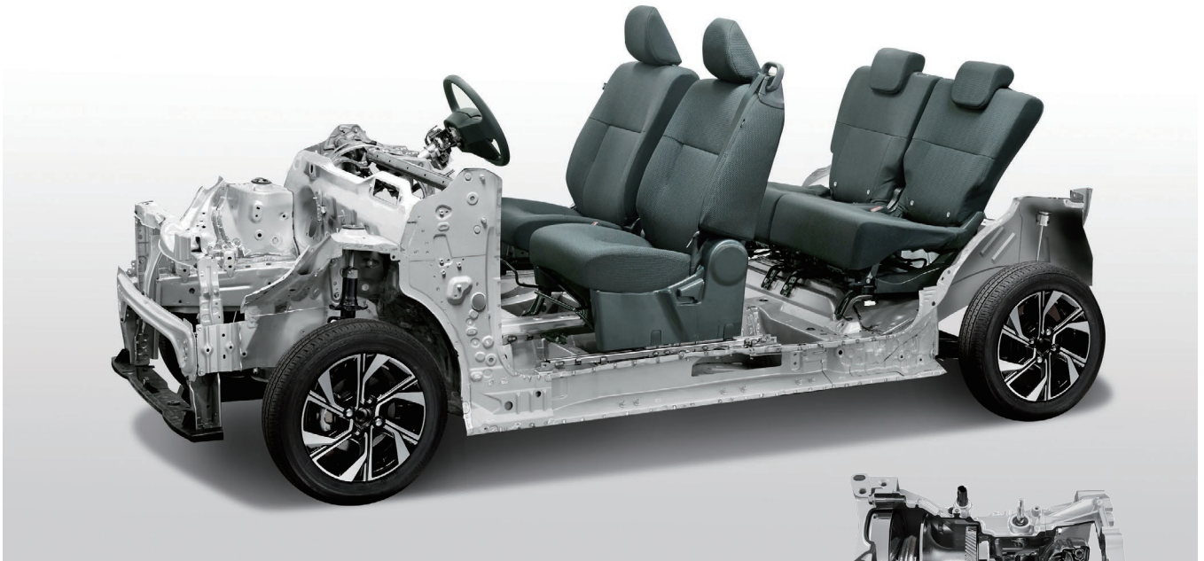
DNGAシャーシ。操縦安定性と乗り心地を重視してサスペンション・ジオメトリーを決定。ステアリング支持剛性も高めている。
