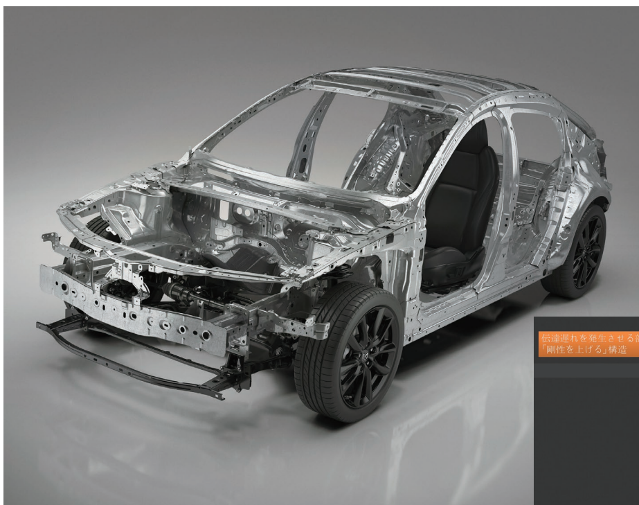
SKYACTIV - Vehicle Architectureを具現化したMAZDA 3のボディ。
