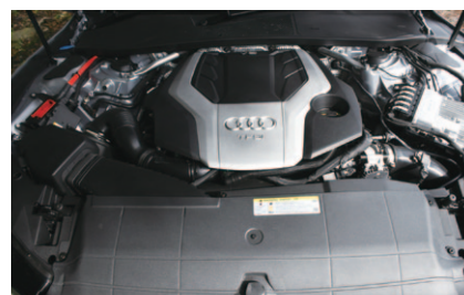
48Vのマイルドハイブリッド(MHEV)。再始動は極めてスムーズ。もちろん回生機能も持つ。
