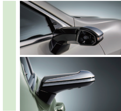
鏡でなくカメラなので小さくできる。死角、空気抵抗、風切り音の低減にもなる。
