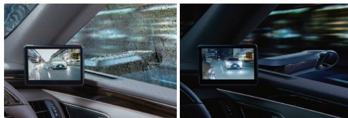
車線変更や右左折時のウィンカー使用時には自動的に視野角を広角に切り替える。
