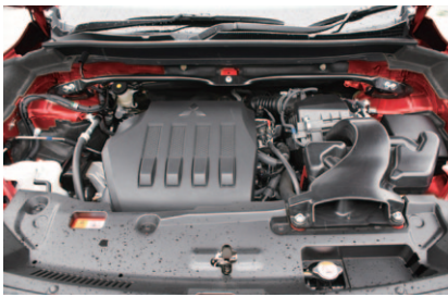
エンジンは1.5ℓ直噴ターボ。最高出力は110kW (150ps)。低速でのトルクも太い。
