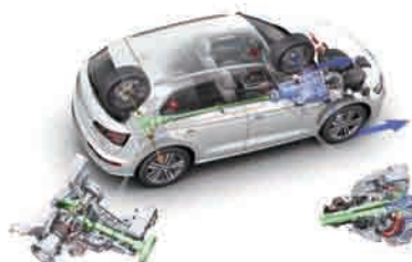
トランスミッション後端のクラッチとリアディファレンシャルに内蔵されたデカップリングクラッチをリリースしてFF状態で走行
