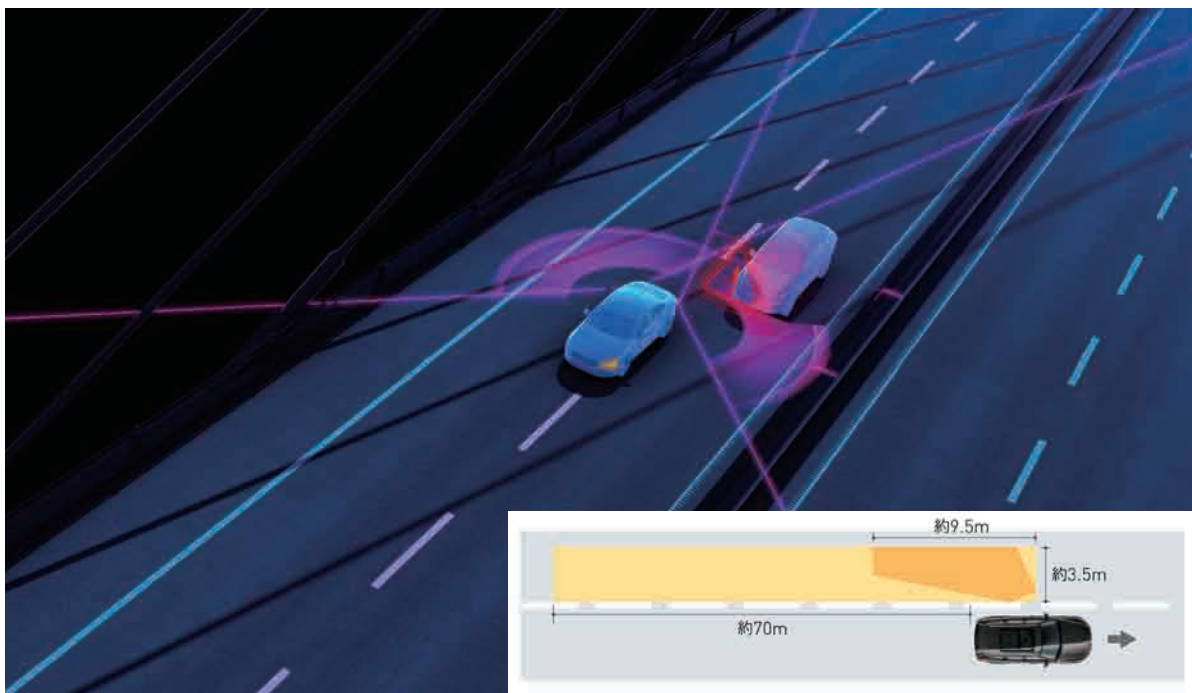
■ 側後方車近接警報のBLISに自動ステアリング操作機能が加えられた。右下図はステアリングアシスト機能付BLISの作動範囲イメージ。 ■
