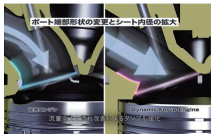
ポート端部を鋭角とすることで流れを剥離、大きな流量係数を達成。
