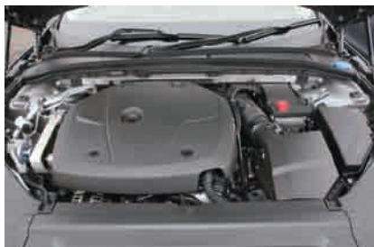
エンジンは2リッター 4気筒。187kW ~ 235kW、そしてPHEVの235kW+モーター。
