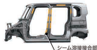
センターピラーまわりに施されたシーム溶接。
