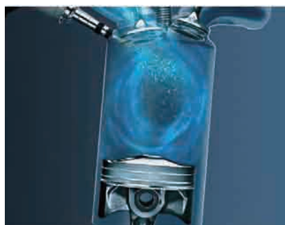
タンブル流を発生する筒内直接噴射のイメージ。
