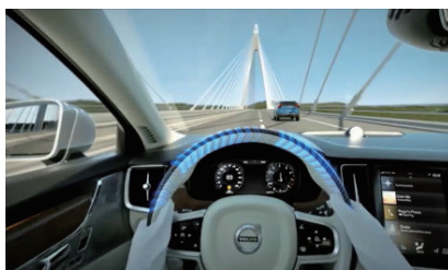
側後方にある車に気がつかずにドライバーが車線変更しようとするとき自動的にステアリング操作を実施
