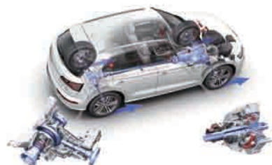
車両の走行状況を常に先読みしてトラクションが必要となる直前に2箇所のクラッチを素早くつないで4WD走行に移行
