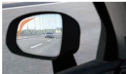
通常のBLIS同様に後方から近づく車をミラーのインジケータで警告。
