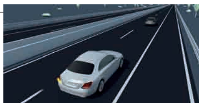
ウインカーを2秒以上点滅させると車線変更がアシストされる
