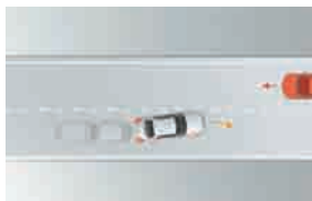
車線逸脱を防止するアクティブレーンキープアシスト
