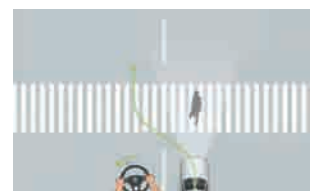
歩行者の出現など緊急時のステアリング回避をアシストする緊急回避補助システム
