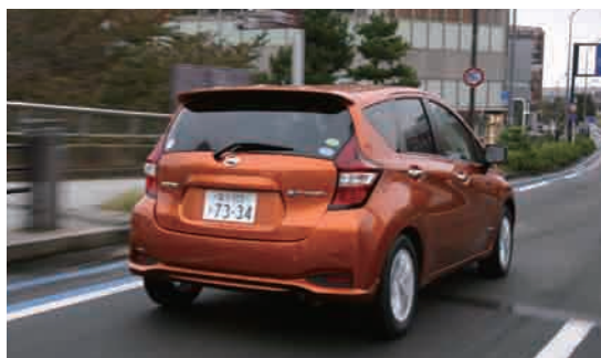
日産のノートe-POWERはエンジンを発電専用にするEV。だからエンジン回転と車速はシンクロしない。エンジン効率を活かしながら発電できるから燃費もいいし航続距離も長い。
