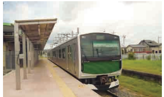
途中から上の架線がなくなる。つまり、ここからは蓄電した電気だけで走る。クルマとの垣根が低くなる可能性も。
