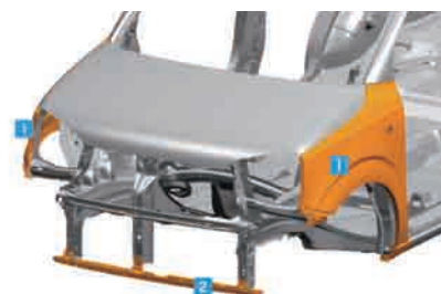
スズキ初となる樹脂フロントフェンダーや樹脂クロスメンバーを採用して軽量化を。
