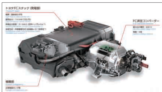
FCスタックのカット図。セルを370枚積層している。体積あたりの出力密度は世界トップレベルの3.1kW/ℓ。
